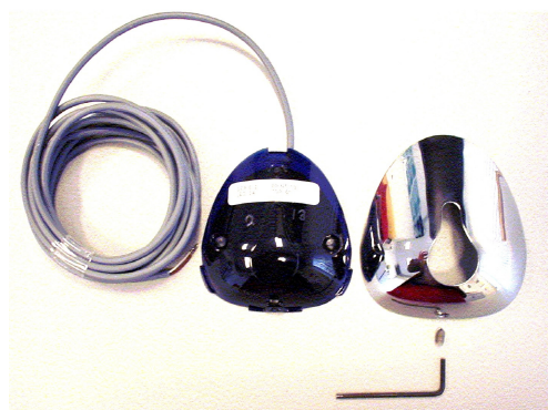
Foto 2: M-sensor met gedemonteerde afdekkap.
